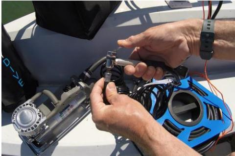
Fixation du mousqueton sur une filière pour que le tuyau ne puisse pas tirer sur le raccord
